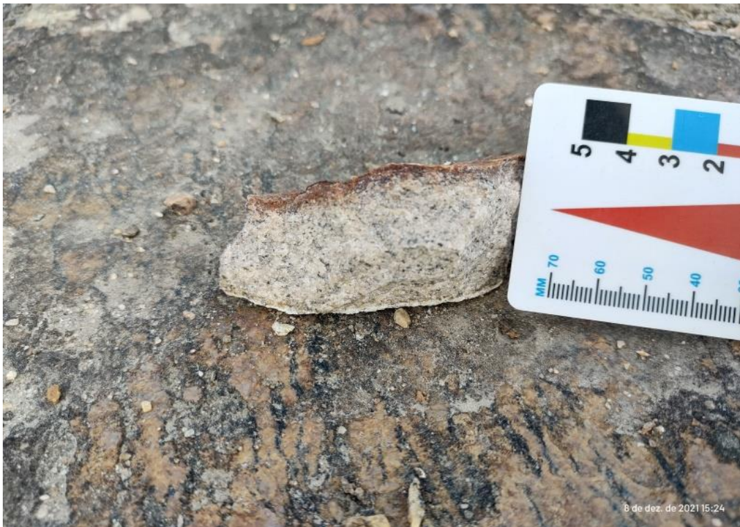
Figura 2.24: Amostra de monzonito com biotitas orientadas retirada do afloramento no ponto F117 (coordenadas UTM 25S 192256/ 9271849).
