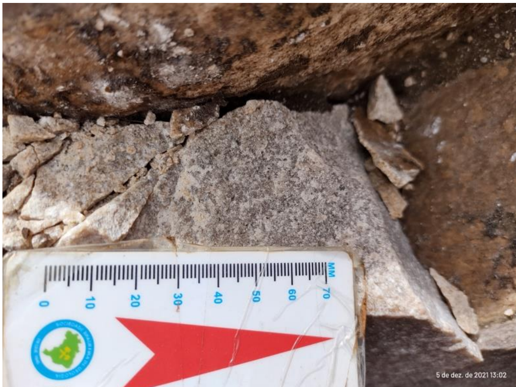
Figura 2.31: Sienogranito com textura fina da unidade Granitoides indiscriminados no ponto F024 (coordenadas UTM 25S 1812116/ 9271788).
